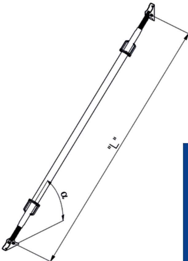
Los resistentes puntales roscados 48RL son fáciles de instalar y tienen una longitud de ajuste de 140 cm. Su sólida estructura combinada con las altas cargas admisibles los hace muy apropiados para apeaar elementos a gran altura así como servir como soportes en la construcción de infraestructuras para servicios, carreteras y canalizaciones de agua.
