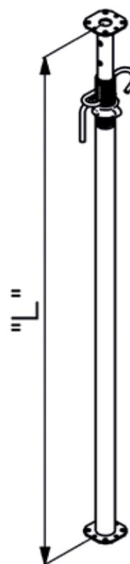
Los puntales roscados pesados del tipo EP30 son apropiados para soportar desde un mínimo de 30 kN en cada tramo extensible, variando de 1.500 hasta 4.000 mm. El puntal está provisto de una rosca exterior para una instalación segura y tiene placas de base y de cabeza planas para una utilización en combinación con sistemas de encofrados o con horquillas. Los puntales EP30 pueden montarse en dos sentidos; con el tubo interior hacia arriba o con el tubo interior hacia abajo.
