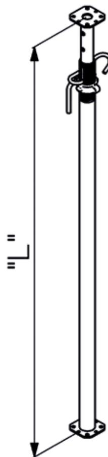
El puntal roscado SG está especialmente indicado para las estructuras de apeo más altas y los encofrados en los que se requiere una alta capacidad de carga. Los tubos exteriores están provistos de una rosca exterior para una instalación segura. Estos puntales incluyen placas de base y de cabeza. El puntal SG puede montarse en dos sentidos: con el tubo interior hacia arriba o con el tubo interior hacia abajo.
