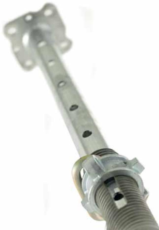
El puntal roscado AN es un puntal de peso medio. Los puntales roscados de tipo AN están provistos de una rosca exterior para una instalación segura, y de placas de base y cabeza planas para una utilización en combinación con sistemas de encofrados o vigas de madera. El puntal roscado AN puede montarse en dos sentidos: con el tubo interior hacia arriba o con el tubo interior hacia abajo.
