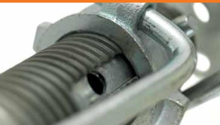
Los puntales roscados de peso intermedio del tipo EP20 son apropiados para soportar desde un mínimo de 20kN en cada tramo extensible, variando ésta desde 1500 hasta 5500 mm. El puntal está provisto de una rosca exterior para una instalación segura y tiene placas de base y de cabeza planas para su utilización en combinación con sistemas de encofrados o con horquillas. Los puntales EP-20 pueden montarse en dos sentidos; con el tubo interior hacia arriba o con el tubo interior hacia abajo.
